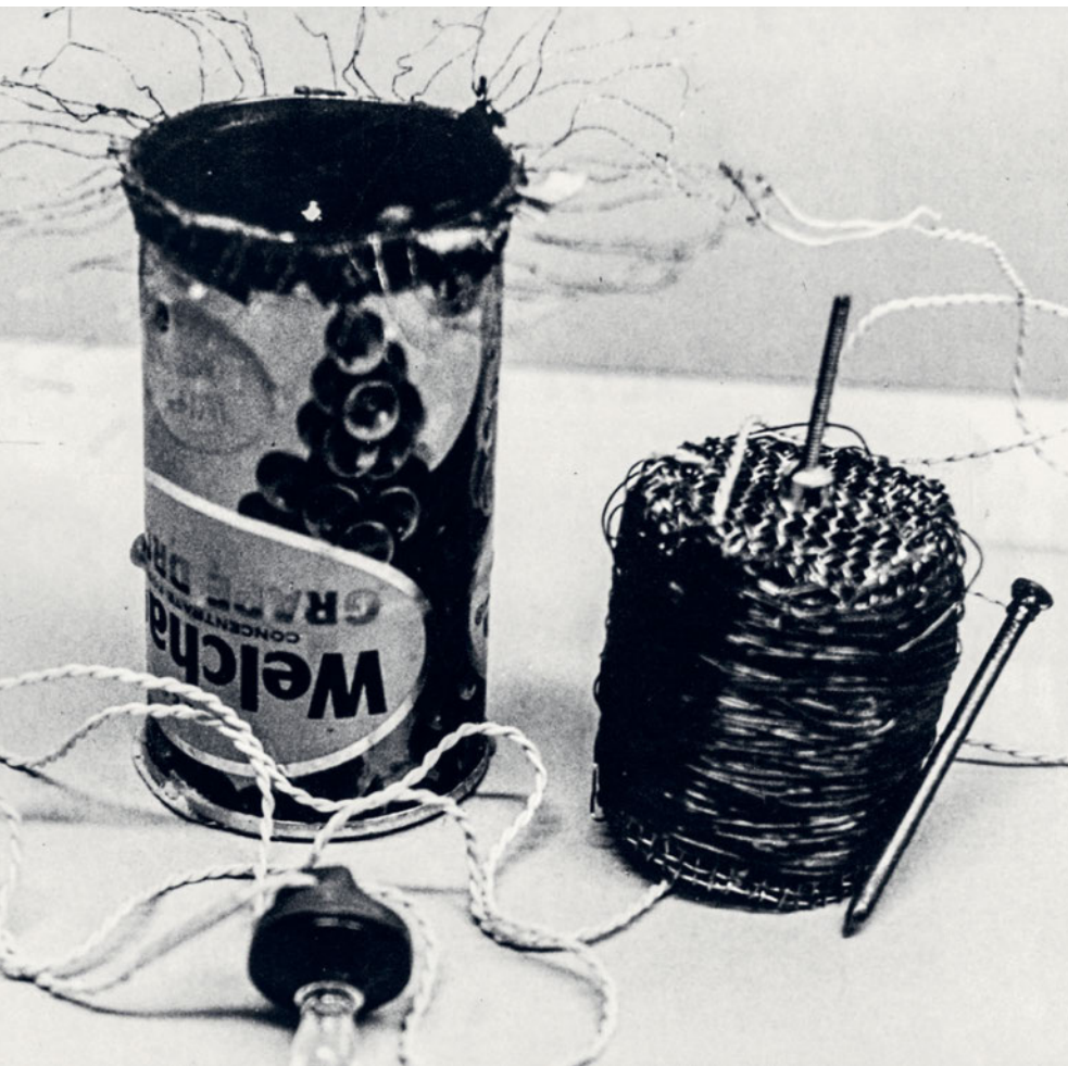
Das berühmte «Tin Can Radio» von Victor Papanek, das er für die UNESCO gestaltete. Eine Blechdose mit einem Transistor, betrieben mit Paraffin und einem Docht.
